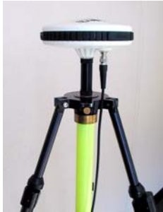
Figure 1.15 Trépied GPS à hauteur fixe avec Extension et antenne GPS
