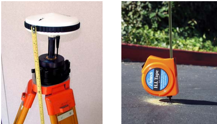
Figure 3.14 Mesure de HI (Hauteur d'Instrument)
