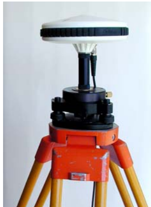
Figure 3.10 Antenne GPS montée sur trépied avec embase à vis calante et extension
